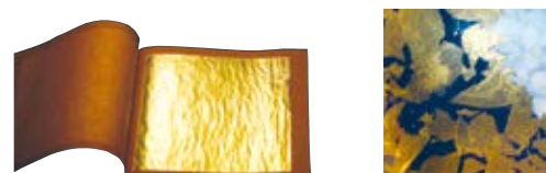
Feuilles d'or avant cuisson et après cuisson à 680°C
